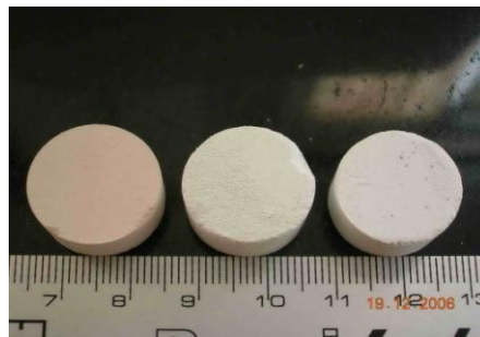
FIG. 4.26 Amostras da mistura Al 2 O 3 -Y 2 O 3 tratadas termicamente, da esquerda para direita, à 1200, 1300 e 1400 °C
