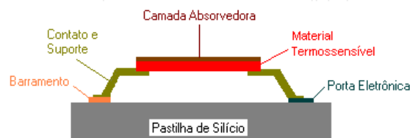
FIG.1. 6 Configuração básica de um microbolômetro, elemento de uma matriz de termodetectores (CASTRO, 2003).
