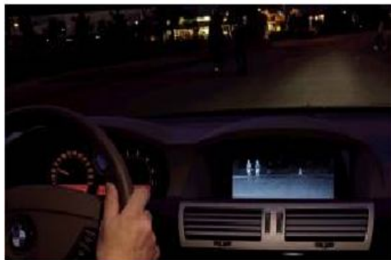
FIG.1. 10 Imagem térmica visualizada no painel de um veículo dotado de uma câmera infravermelha. (MOTORING, 2006).
