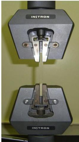
FIG 3.5 Garras de fixação de amostras.
