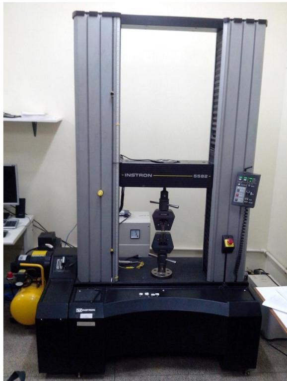
FIG 3.4 Máquina de Ensaio Universal Instron modelo 5582.
