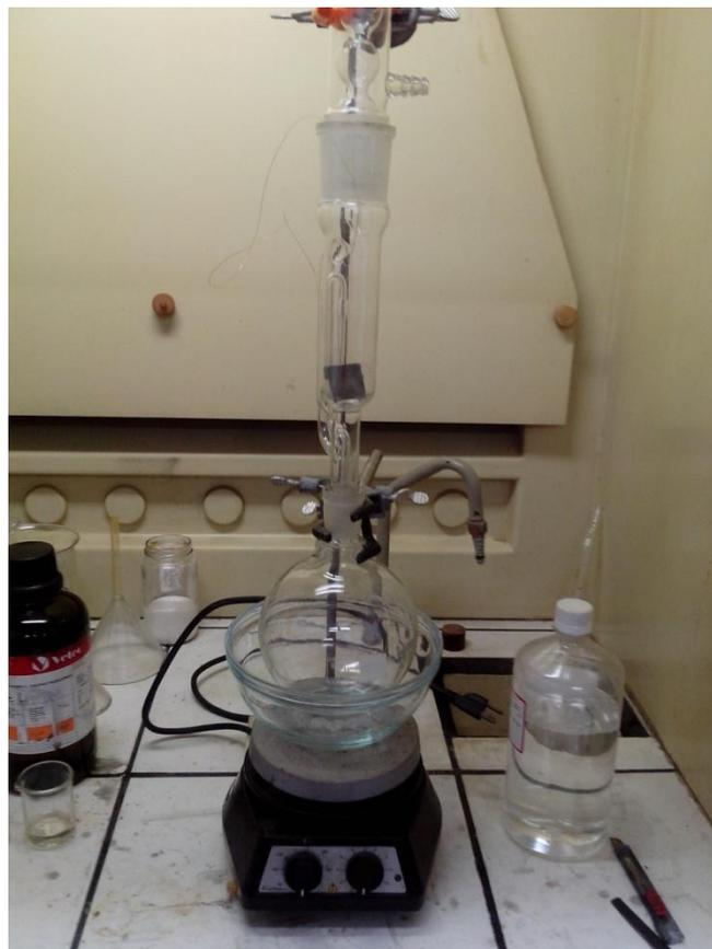
FIG 0.1 Esquema montado para realização do ensaio de Teor de Gel.
