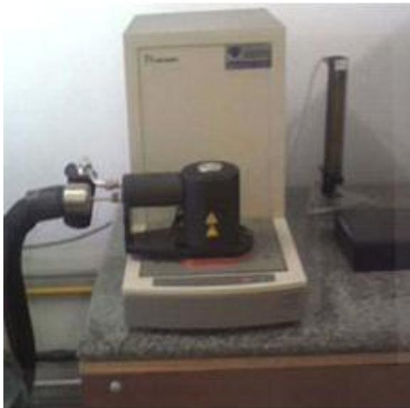
FIG 3.11 Equipamento de análise térmica DSC.
