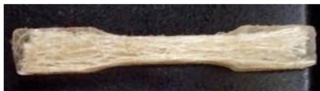
FIG 3.8 Corpo de prova de tração para os compósitos.
