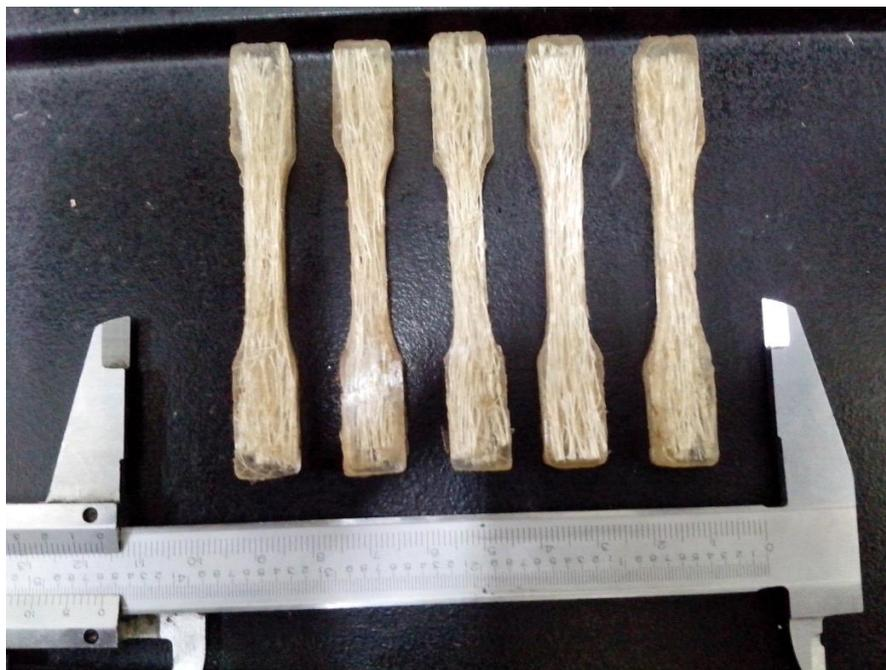
FIG 3.7 Compósitos com 20% em volume de fibras de bucha.
