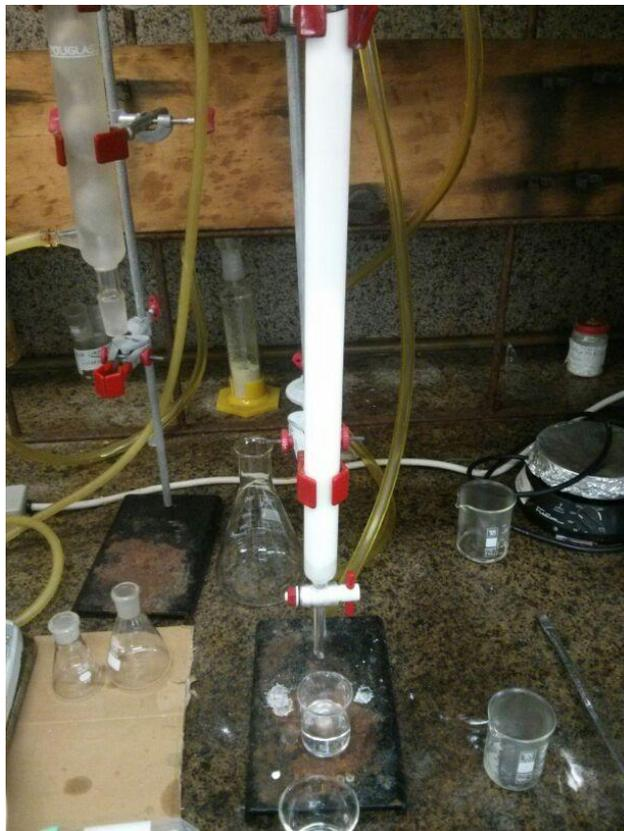
FIG 0.3: Coluna de alumina básica grau I, para purificação de THF.
