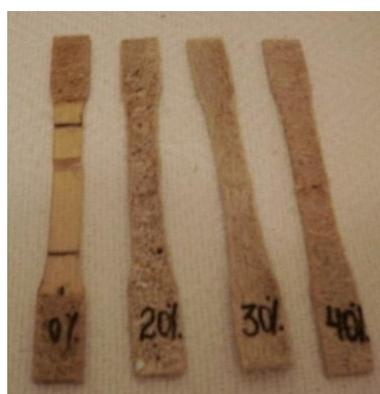
FIG 2.7 Corpos de prova de compósitos de poliéster reforçados com 0 %, 20 %, 30 % e 40 % em volume de bucha vegetal, rompidos à tração (SILVA e MOTTA, 2012).
