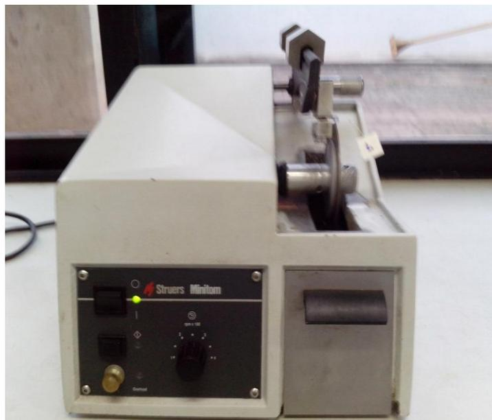
FIG 3.3 Minitom utilizado para cortar as capsulas utilizadas no ensaio de pullout.
