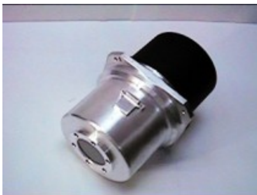
FIG. 1.13 - Protótipo de sensor de horizonte, desenvolvido pelo Grupo de Eletro-Óptica do INPE ( http://www.dea.inpe.br/grupos/sens/capacitacao_sens.php ).
