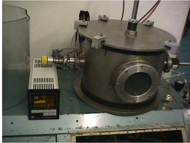
Fig. 5.2 - Fotografia do sistema de deposição por pulverização catódica utilizado.
