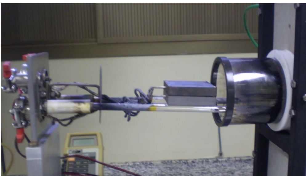
FIG. 3.2 Câmara de quartzo aberta: detalhe dos blocos de grafite.
