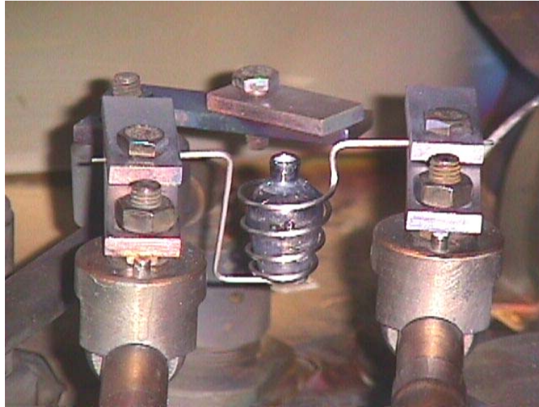
FIG. 5. 3 - Cadinho tipo célula de Knudsen.
