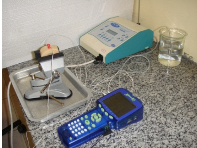
FIG.3.5 - Montagem do dispositivo empregado nos ensaios de furação manual.
