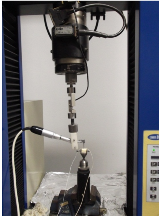
FIG. 3.7 - Dispositivo mecânico preparado na máquina universal de ensaios para o ensaio de furação sem a interferência do operador.
