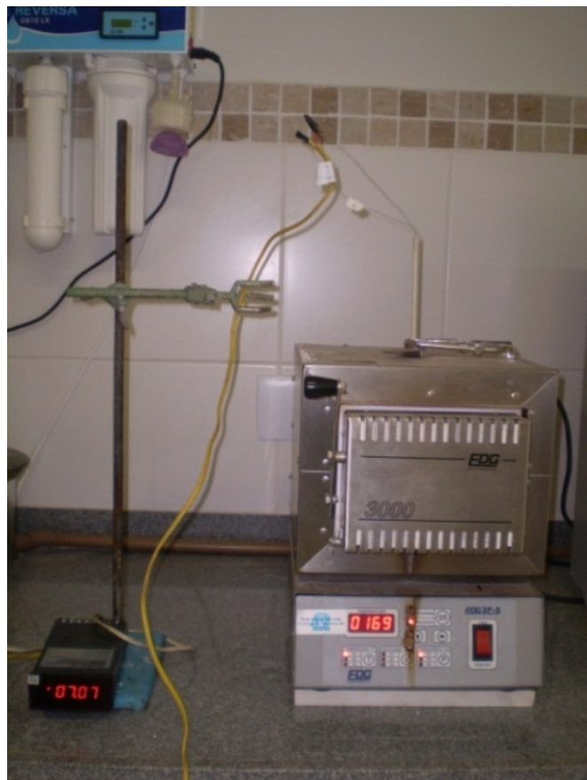
FIG. 3.9 - Equipamento utilizado para o tratamento térmico das amostras de aço inoxidável.
