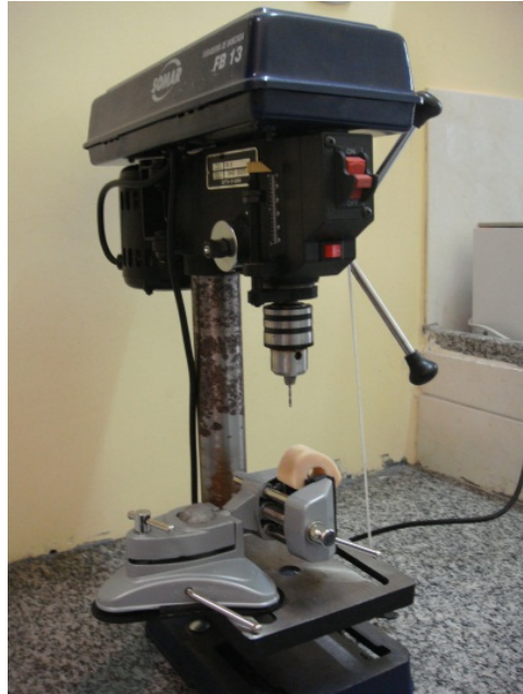
FIG. 3.2 –Furadeira de bancada com a amostra de osso cortical fixada no torno de mesa.
