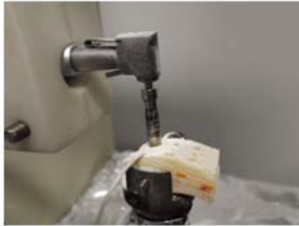
FIG. 3.8 - A amostra de osso cortical bovino fixada ao torquímetro para os ensaios de furação na EMIC.
