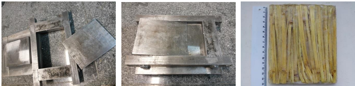
(a) (b) (c) Figura 21 – (a) Peças da matriz separadas; (b) indicação do modo de encaixe das peças; (c) exemplo de placa compósita obtida pela prensagem.
