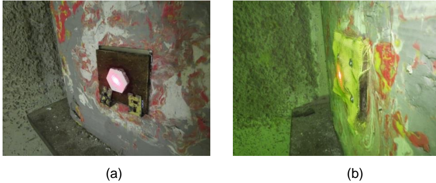
Figura 44 (a,b) - Modos de fixação dos CPs na plastilina.
