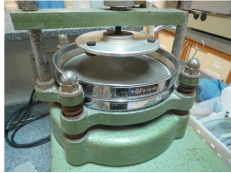
Figura 16 - Agitador de peneiras (IME)
