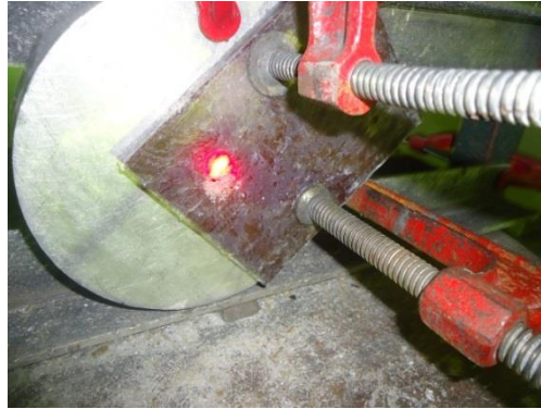
Figura 28 - Placa Compósita Resina-Tecido de Rami, afxada para o ensaio sem plastilina
