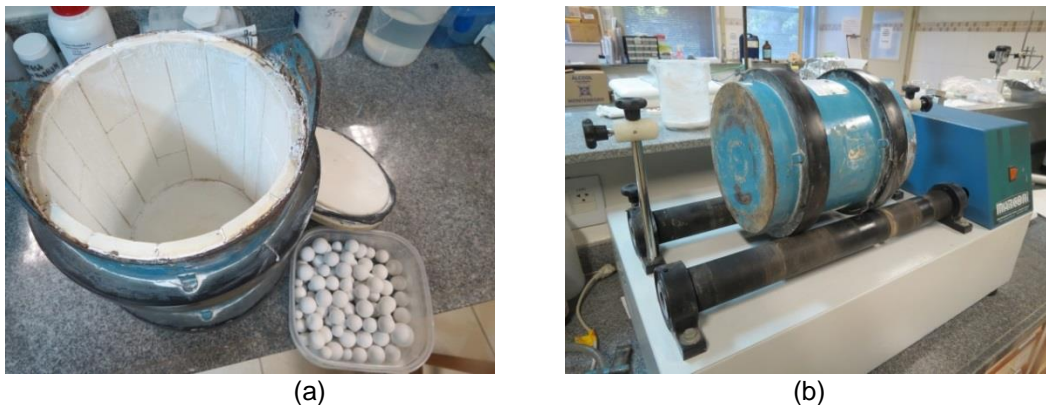
Figura 13 – (a) Moinho de bolas Marconi modelo MA 500 aberto; (b) em posição de funcionamento (IME)
