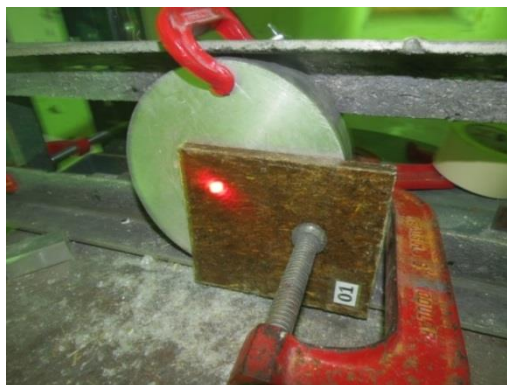
Figura 29 - Placa Compósita Resina-Fibra Bruta de Rami, pronta para o ensaio sem plastilina
