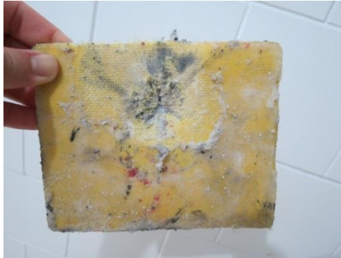
Figura 30 - Placa Compósita Resina-Aramida (visão do pós-impacto).
