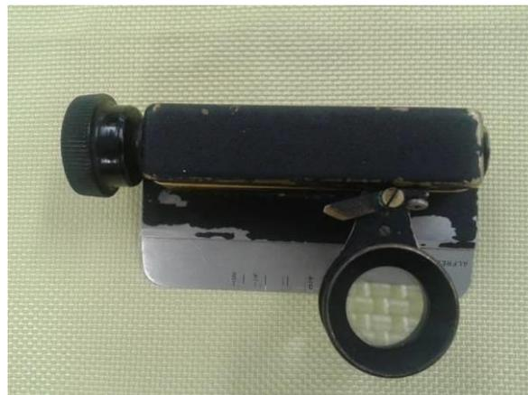
FIG. 3.12 Fotografia do equipamento para contagem do número de fios.
