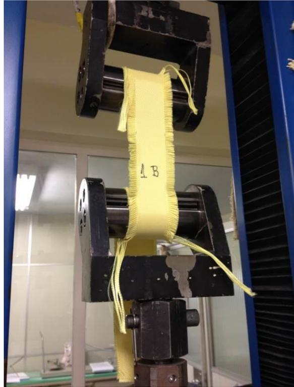
FIG. 3.14 Fotografia da máquina universal para ensaios de tração EMIC, modelo DL 10000.
