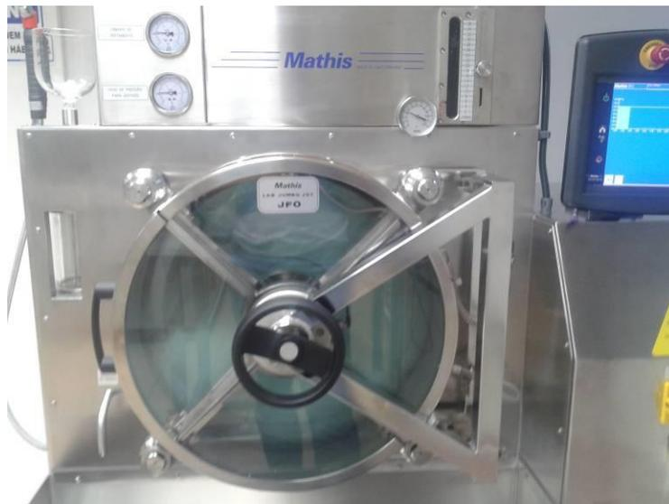
FIG. 3.9 Fotografia do aparelho para tingimento sobre fluxo e jato Werner Mathis AG, modelo JFO.
