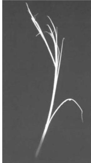
FIG. 2.27 Fratura da fibra de poliaramida
