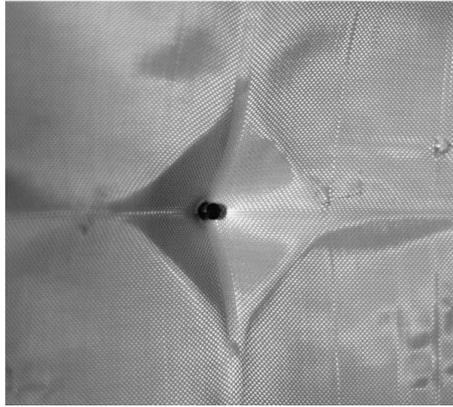
FIG. 2.26 Deformação cônica de um tecido de poliaramida após o impacto balístico.
