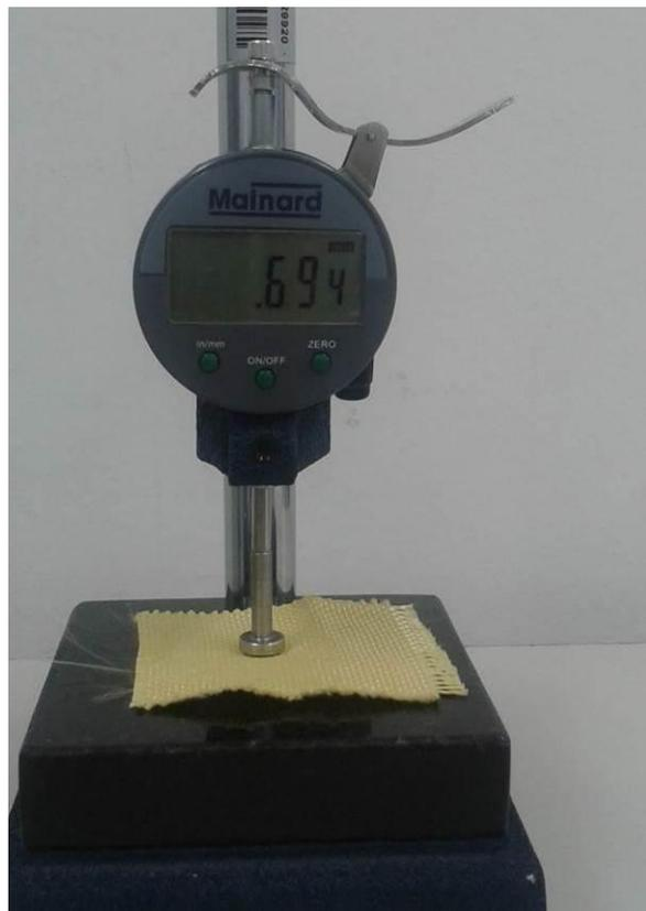
FIG. 3.13 Fotografia do equipamento para medição da espessura Mainard.
