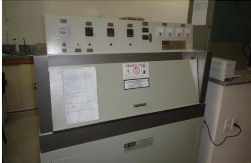
FIG. 3.7 Fotografia da câmara da marca Comexim modelo C-UV.
