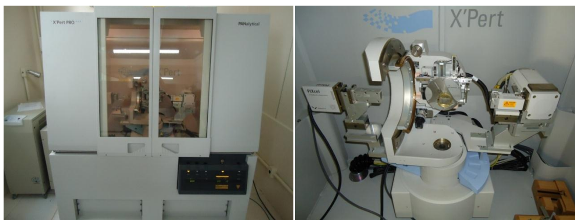
Figura 19- (a) Difratômetro de raios x e (b) goniômetro do IME.
