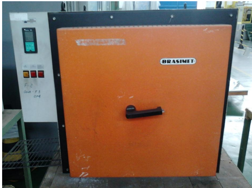
Figura 35- Forno de tratamento térmico de recozimento.
