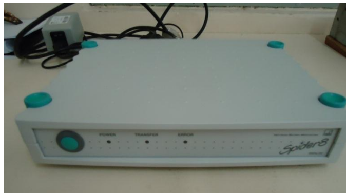
Figura 31- Spider, equipamento que mede as deformações dos extensômetros.
