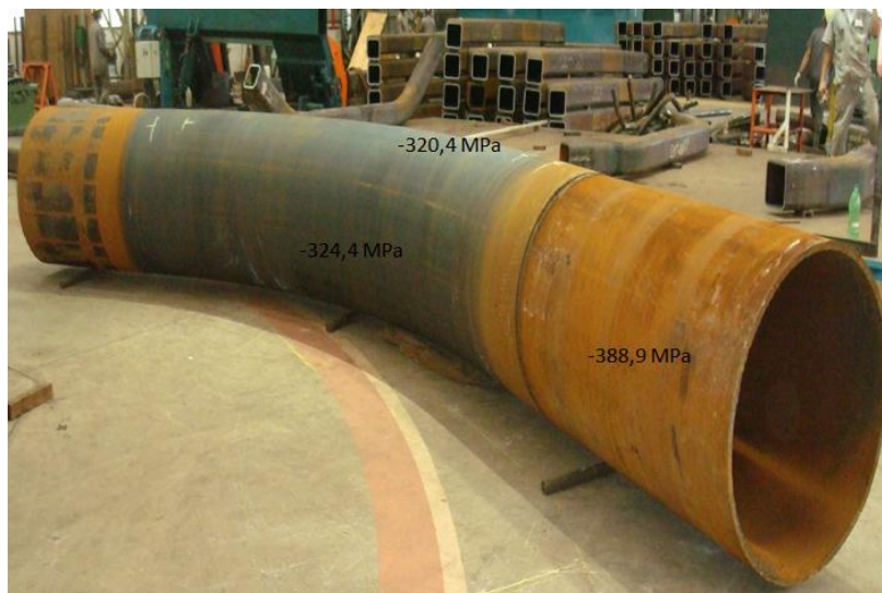
Figura 74- Tubo com as tensões residuais nas regiões: Curva Intradorso, Linha Neutra e Trecho Reto.
