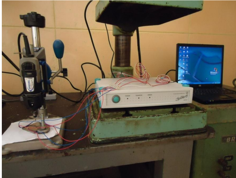
Figura 34- Instalação dos equipamentos para realização do furo.
