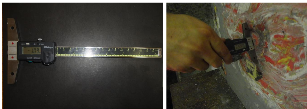
FIG. 4.3 – (a) Paquímetro utilizado e (b) medição da indentação causada na plastilina pelo impacto do projétil.
