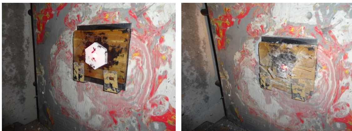
FIG. 4.2 – Blindagem multicamada com compósito de epóxi reforçado com plaquetas de bambu, (a) antes e (b) após ensaio balístico.
