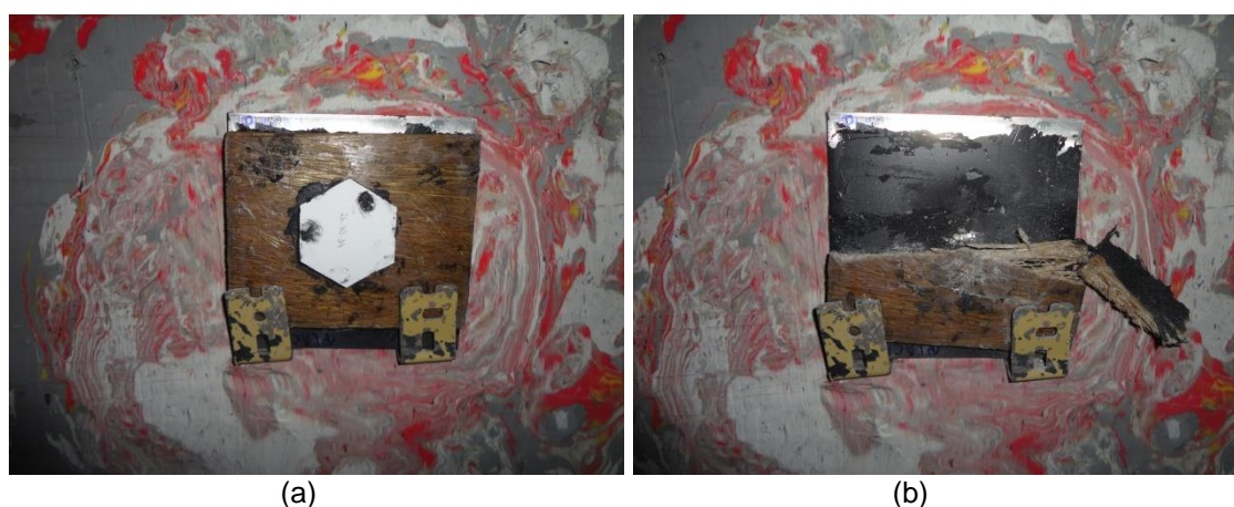
FIG. 4.1 - Blindagem multicamada com compósito de epóxi reforçado com fibras de bambu, (a) antes e (b) após ensaio balístico.
