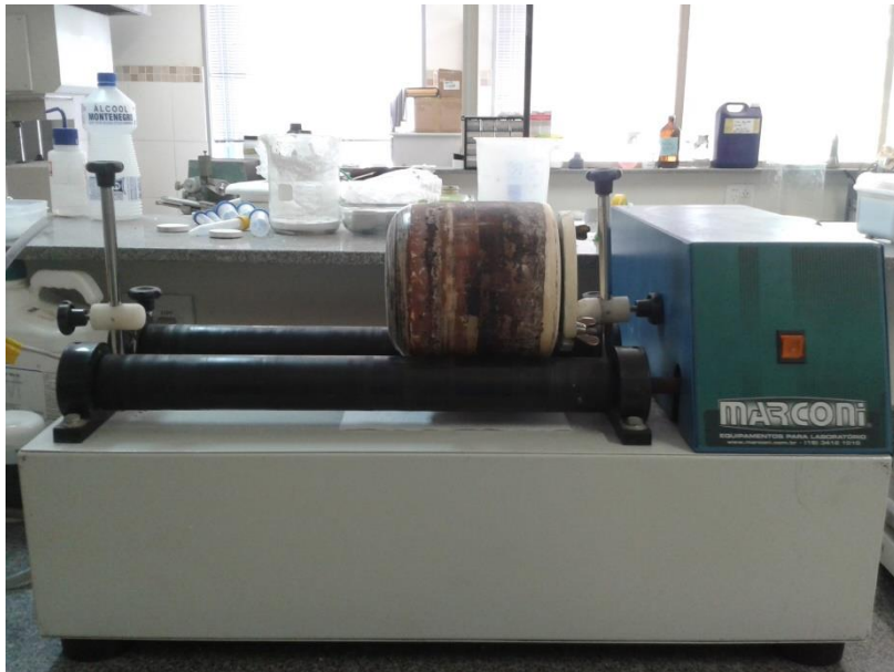
FIG. 3.5 – Moinho de bolas Marconi modelo MA 500.
