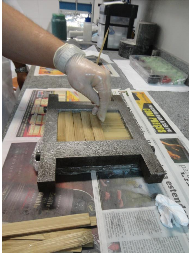
FIG. 3.14 – Confeção da placa compósita de plaquetas de bambu.
