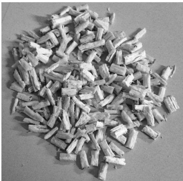
**FIG 4.2** Bagaço de cana usado para sorção
