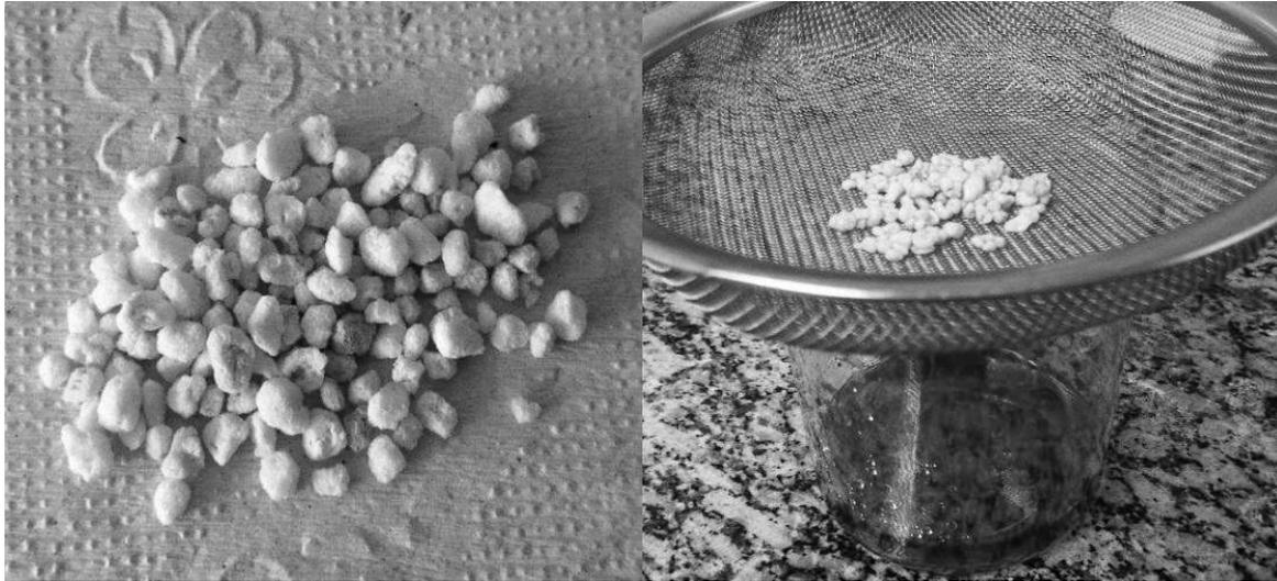
**FIG. 4.1** – (a) Perlita peneirada usada para sorção e (b) perlita impregnada com óleo.
