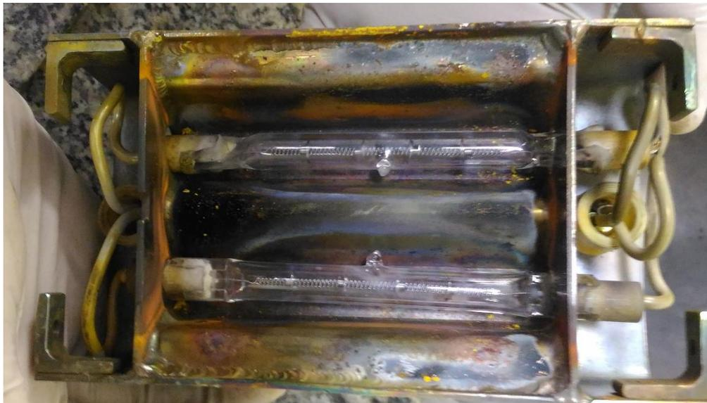
Figura 5.35 Aquecedor do CSS contaminado.
