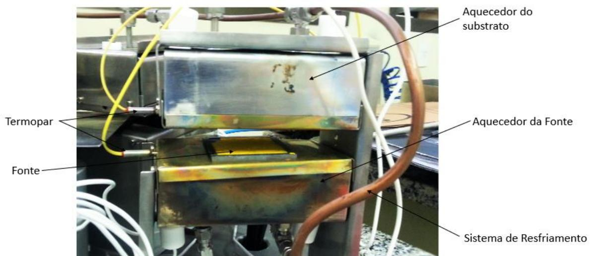
Figura 4.1 Reator do sistema de deposição CSS.
