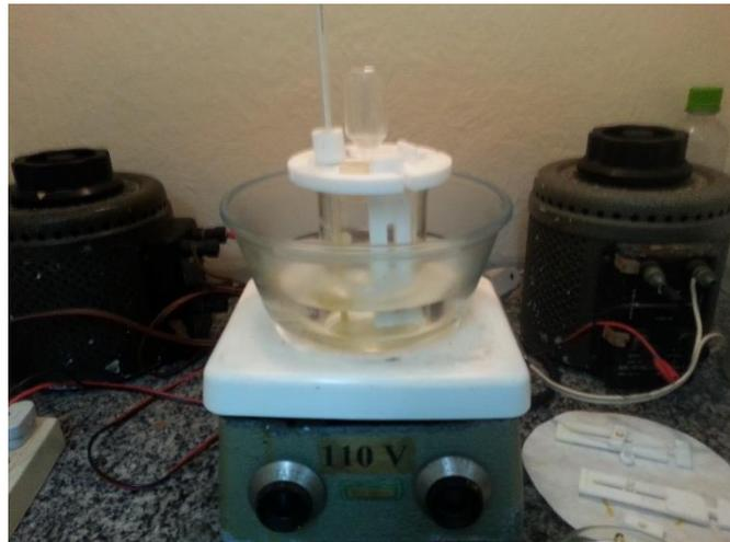
Figura 4.6 Sistema usado para deposição por CBD
