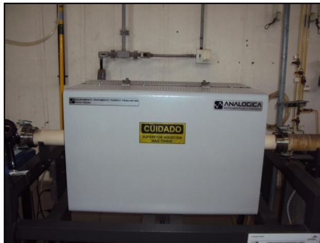
FIG.3.1 Forno tubular utilizado na interrupção do ciclo de descarbonetação.
