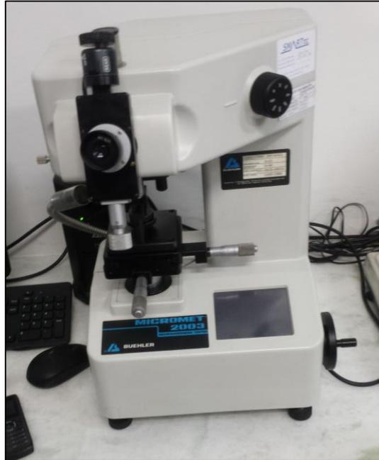
FIG. 3.20 Microdurômetro MICROMET 2003 BUEHLER.
