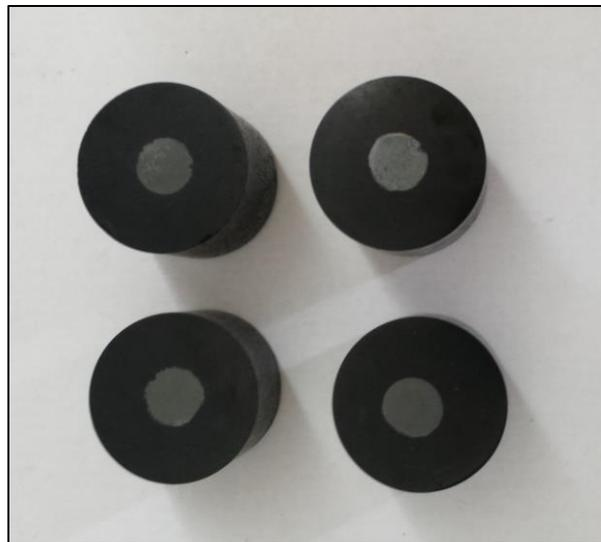
FIG. 3.19 Amostras embutidas com baquelite para ensaio de dureza.
