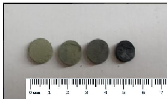
FIG. 4.12 Pastilhas após a sinterização em forno resistivo.
