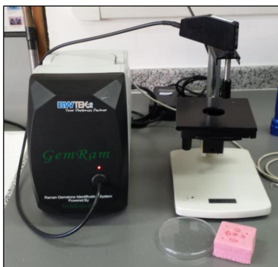
FIG. 3.10 Aparelho de Espectroscopia Raman.
