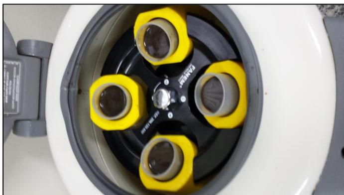
FIG. 3.7 Tubos tipo Falcon de 50 ml da centrífuga utilizada.
