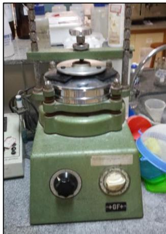
FIG. 3.15 Agitador para lavar areias marca GF, modelo TWB.
