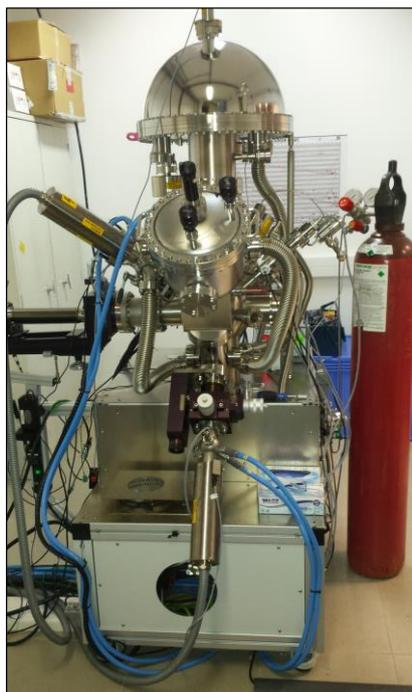
FIG. 3.11 Aparelho de Espectroscopia XPS.
