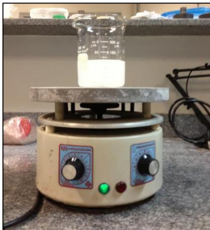
FIG. 3.3 Agitador Magnético Quimib, modelo Q261-12.
