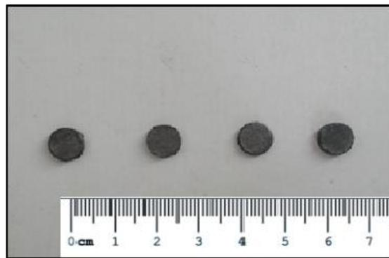
FIG. 4.13 Pastilhas após a sinterização por SPS.
