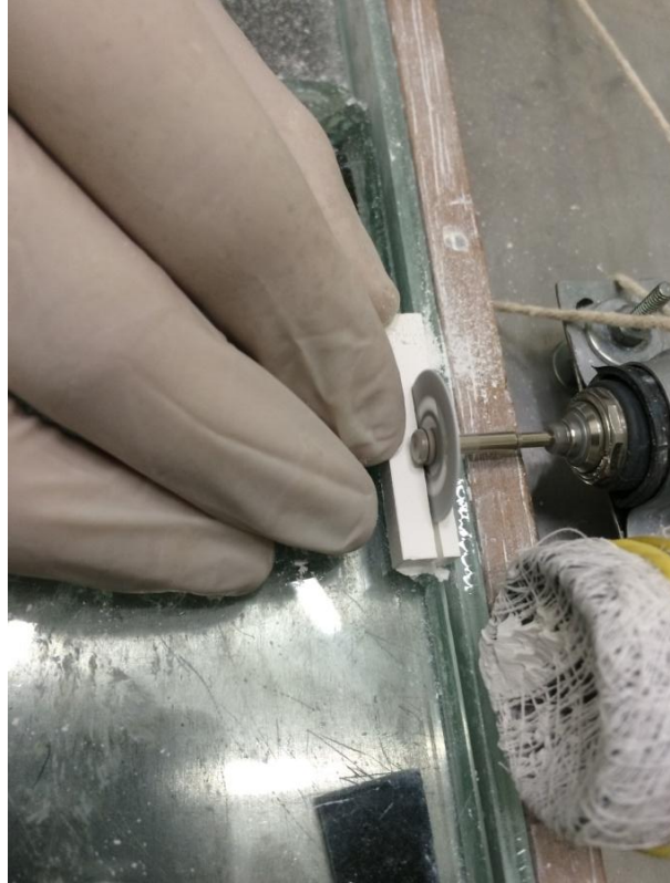
FIG 4.1 Dispositivo utilizado para o corte dos blocos de zircônia.
