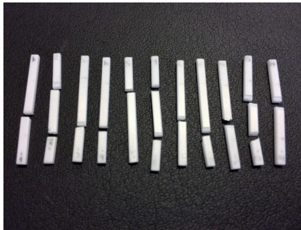
FIG 5.14 Padrões de fratura encontrados durante a fratura dos corpos de prova nos ensaios de flexão em quatro pontos.
