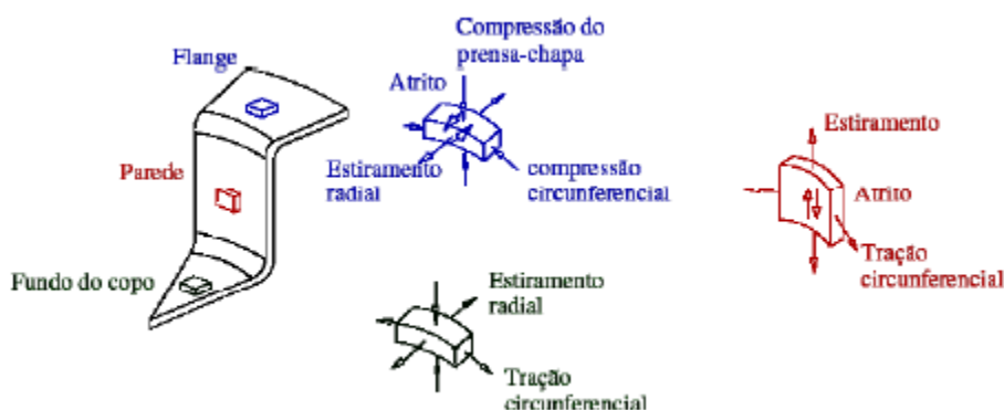
FIG 2.2: Esforços atuantes nas diferentes regiões do copo (LORENT, 1980).
