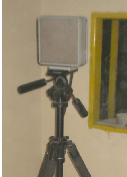
FIG. 3.15 Radar Doppler, Weibel, modelo SL-520P.
