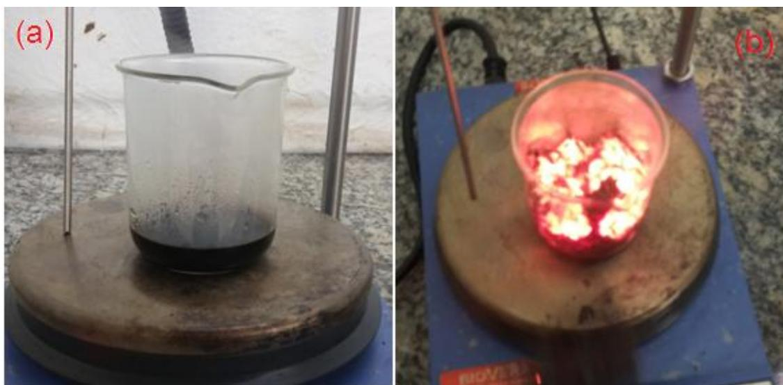
FIG. 3.1 (a) Solução em Aquecimento ( $100^\circ C$ ). (b) Combustão da Solução.
