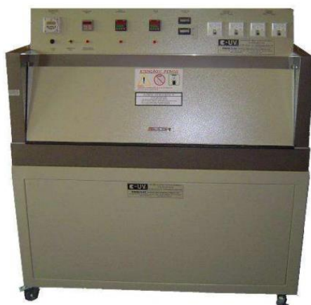
FIG. 3.2: Sistema de envelhecimento acelerado para não metálicos; ultravioleta / condensação (Catalogo de produtos da Comexim).
