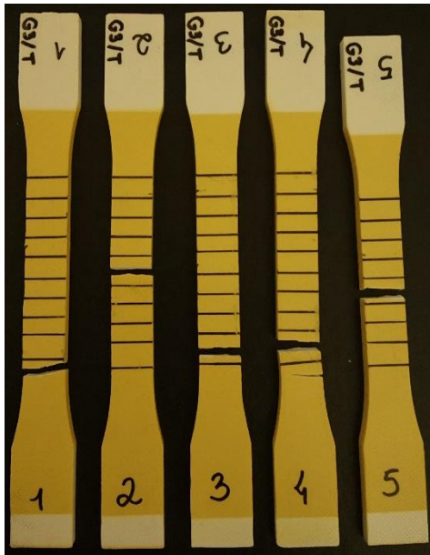
FIG. 8.57: Corpos de prova fraturados do poliestireno irradiado por 336 horas em tração e fadiga, respectivamente.
