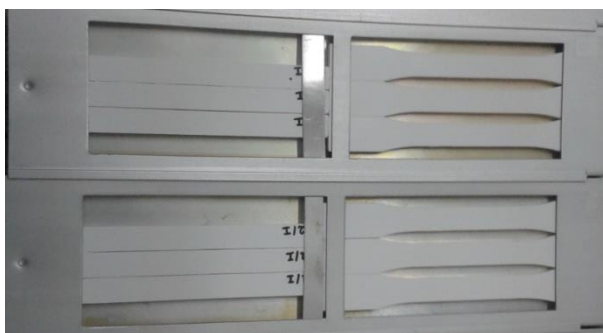
FIG. 3.3: Disposição das amostras no equipamento de UV.
