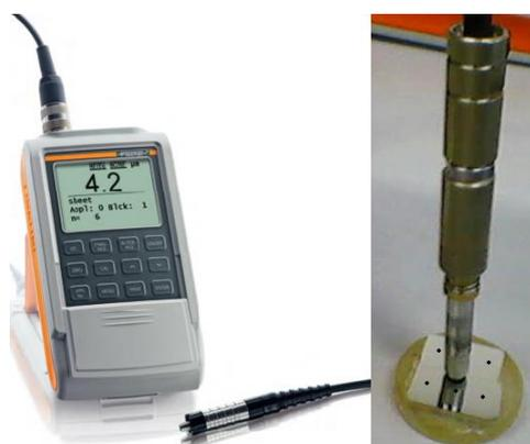
FIG 3.2: Representação esquemática da quantificação de fase por ferritoscopia.
