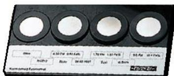
FIG 2.7: Conjunto de amostras padrão de ferrita para calibração do ferritoscópio (OPERATORS MANUAL FERITSCOPE® FMP30, 2008).
