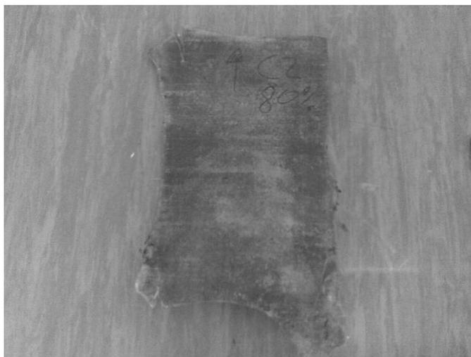
FIG. 5.1 Chapa de laminação cruzada com 80% de redução total.
