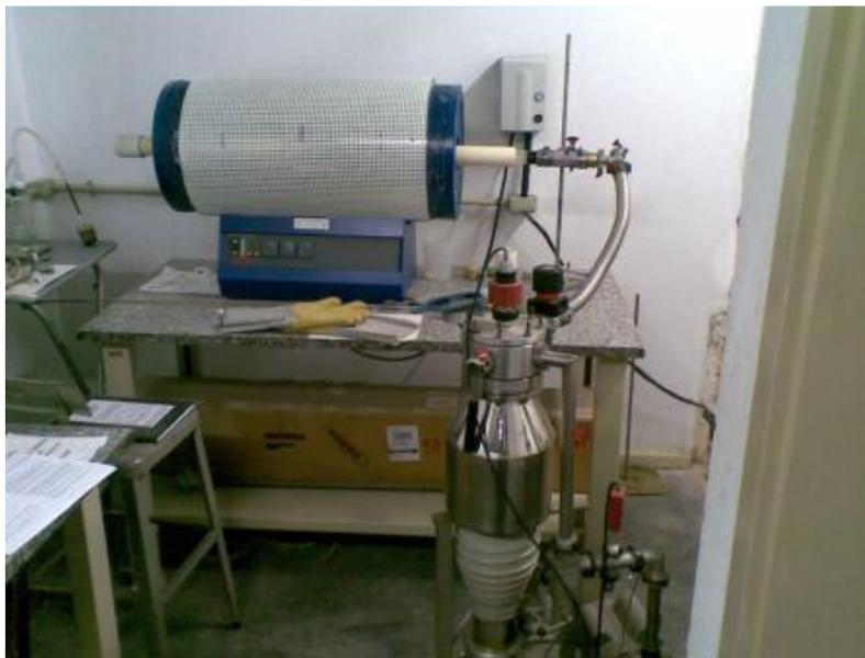
FIG. 3.6 Forno usado para recozimento das amostras.
