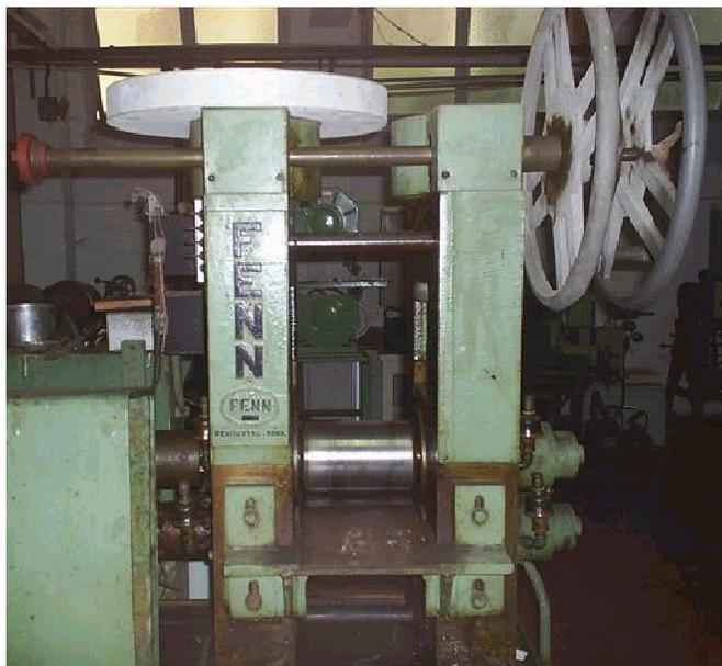
FIG. 3.3 Laminador reversível FENN do laboratório de fundição do IME.
