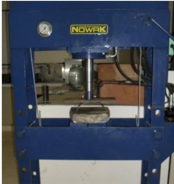
FIG. 3.5 Prensa usada para desempenar as chapas.
