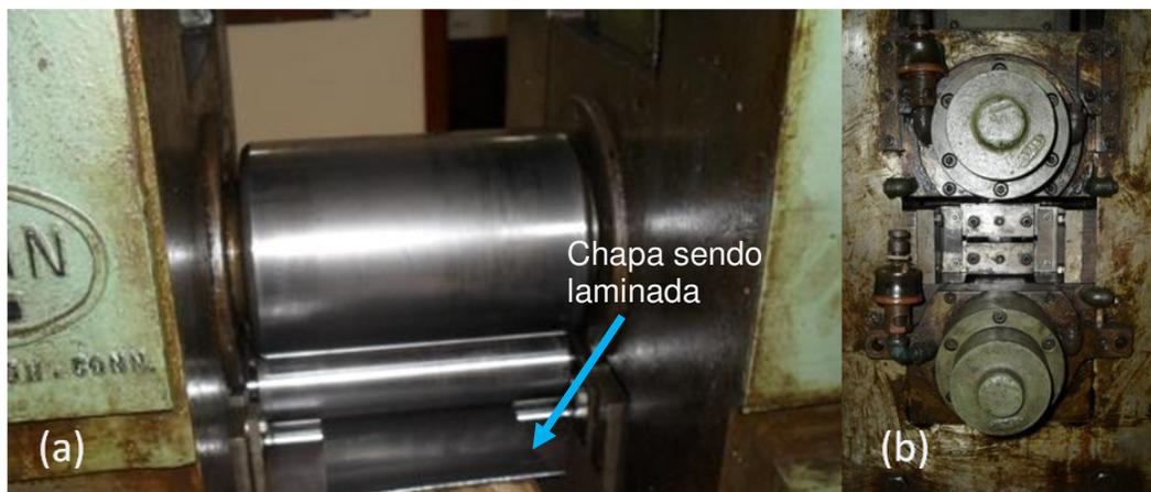
FIG. 3.4 Geometria dos cilindros a) vista frontal; b) vista lateral.
