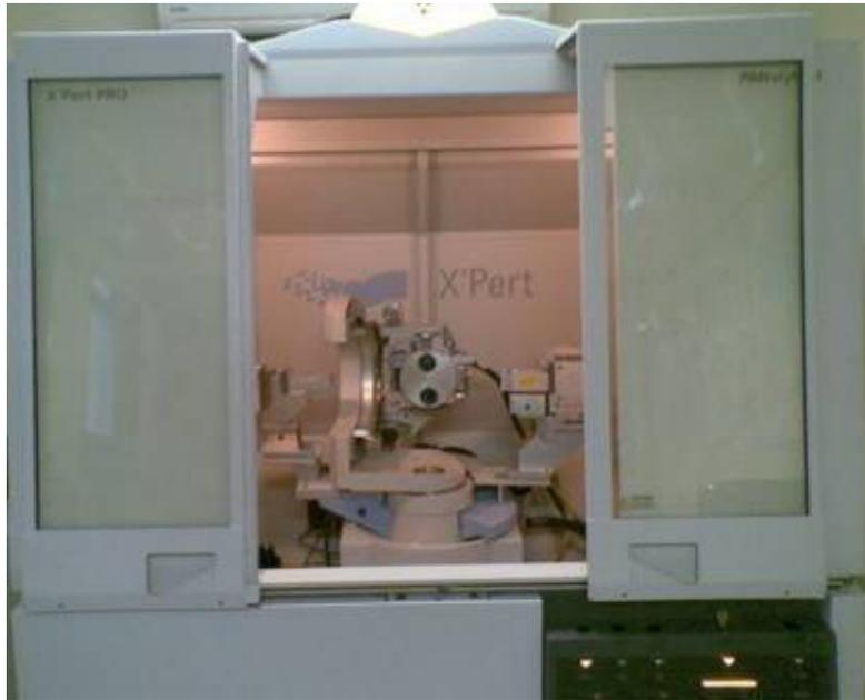
FIG. 3.8 Equipamento usado para análise de textura cristalográfica.
