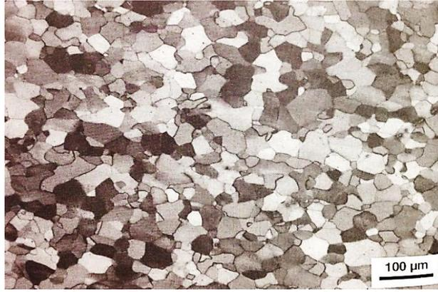
FIG 2.2: Aço IF (C = 26 ppm, N = 30 ppm, Ti = 600 ppm) recozido. Grãos de ferrita poligonais. Aumento: 100x. Ataque: Klemms (COLPAERT, 2008).
