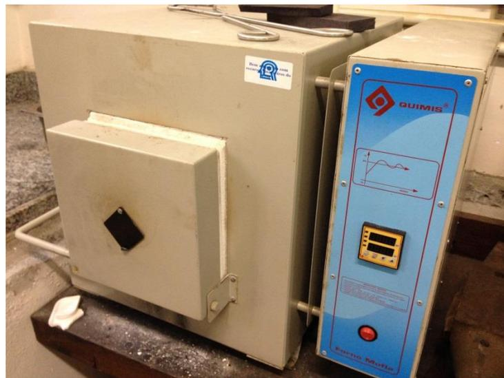
FIG 3.5: Forno mufla microprocessado do IME, modelo Quimis Q318M.
