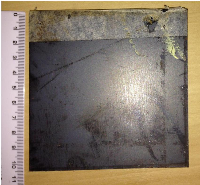
FIG 3.1: Amostra de aço IF como recebida da CSN.
