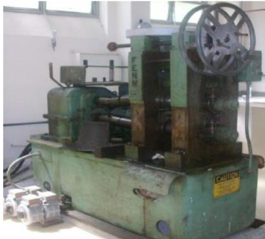
FIG 3.4: Laminador FENN MFG. Co., modelo D 51710 de 1973. Laboratório de Processamento Termomecânico do IME.
