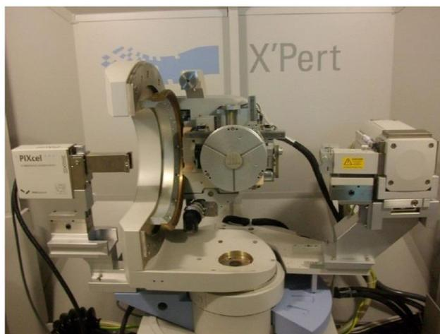
FIG 3.11: PANalytical X'Pert PRO MRD do laboratório de difração de raios-x do IME (BOTELHO, 2012).
