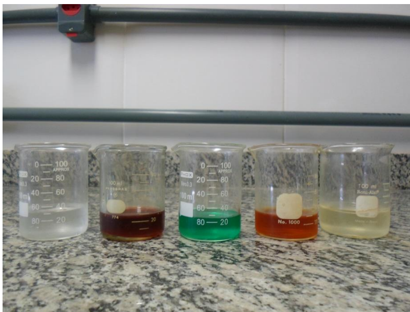
FIG 5.1 Da esquerda para a direita: nitratos de zinco, ferro, níquel, cobalto e glicina, diluídos em água destilada.
