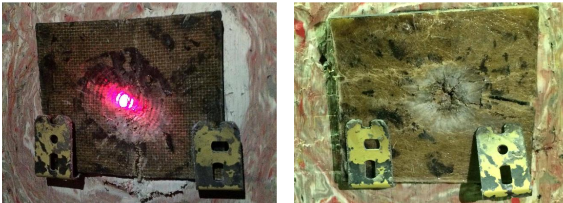
FIG. 4.1 Sistema de blindagem multicamada após o disparo da munição de calibre 7,62x51 mm: (a) Tecido e (b) manta de juta.
