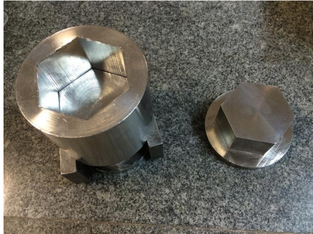
FIG. 3.7 Matriz utilizada na moldagem dos corpos cerâmicos.
