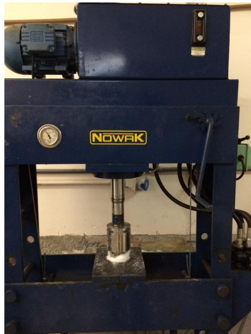
FIG. 3.8 Prensa hidráulica semiautomática NOWAK, com capacidade para 30 toneladas.
