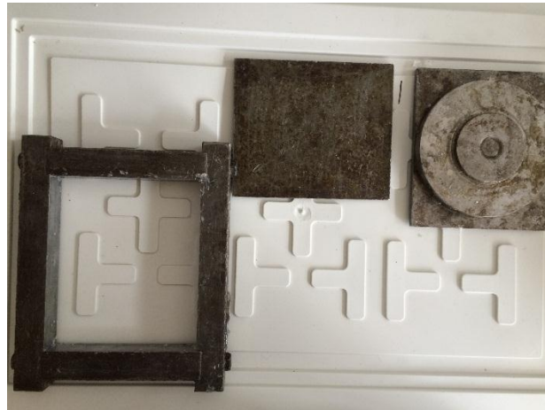
FIG. 3.10 Matriz metálica utilizada na preparação das placas de compósito poliéster-juta.
