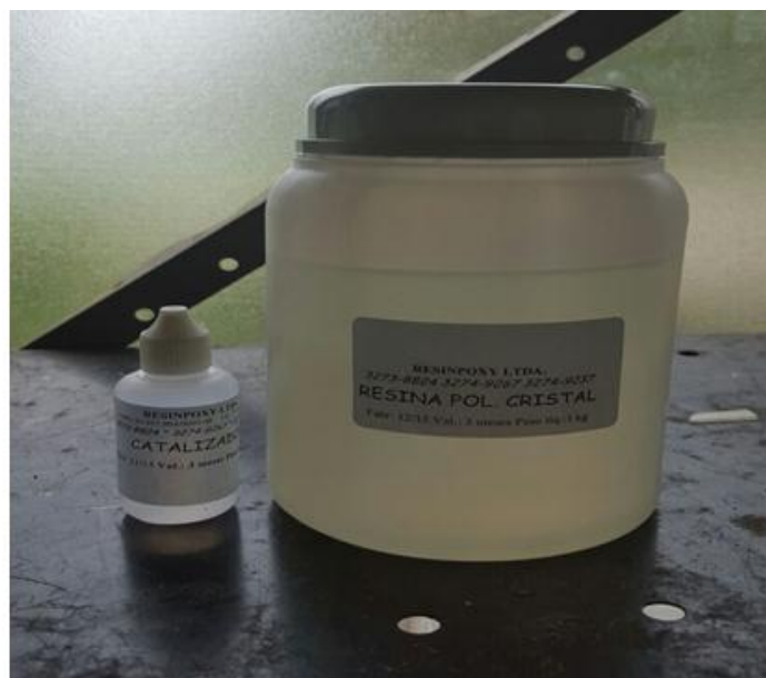
FIG. 3.2 Resina poliéster e o catalisador metil-etil-cetona.
