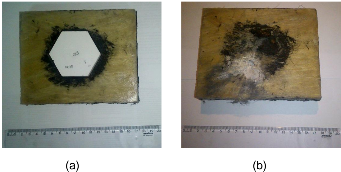
FIG. 4.27 Ensaio relativo à indentação elevada: corpo de prova com 30% de Curauá bidirecional (a) antes e (b) após o impacto.
