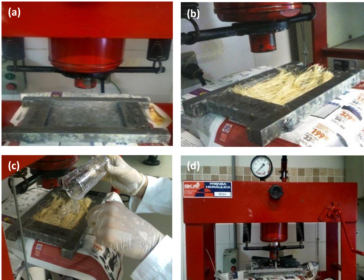
FIG. 3.11 Etapas da fabricação dos compósitos: (a) lubrificação da matriz; (b) acondicionamento das fibras; (c) acondicionamento da resina; (d) prensagem.
