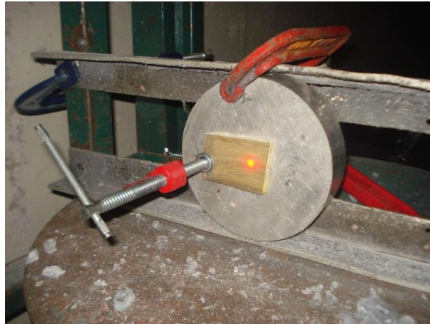
FIG. 3.17 Dispositivo de fixação das placas no ensaio de velocidade residual, utilizado para fixar um compósito reforçado com fibra de Curauá.
