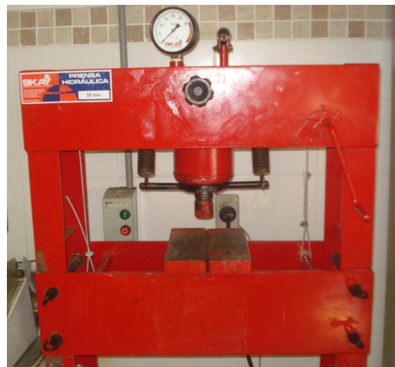
FIG. 3.10 Prensa hidráulica SKAY, com capacidade para 30 toneladas.
