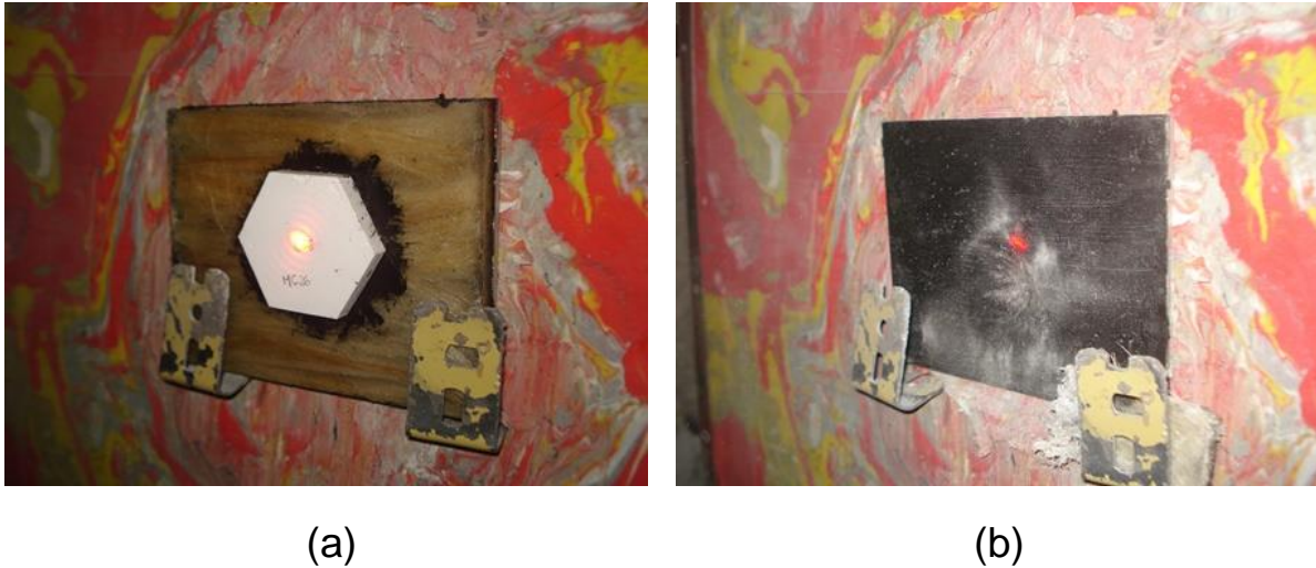
FIG. 4.16 Blindagem multicamada com 10% de Curauá: (a) Antes e (b) após o impacto balístico.
