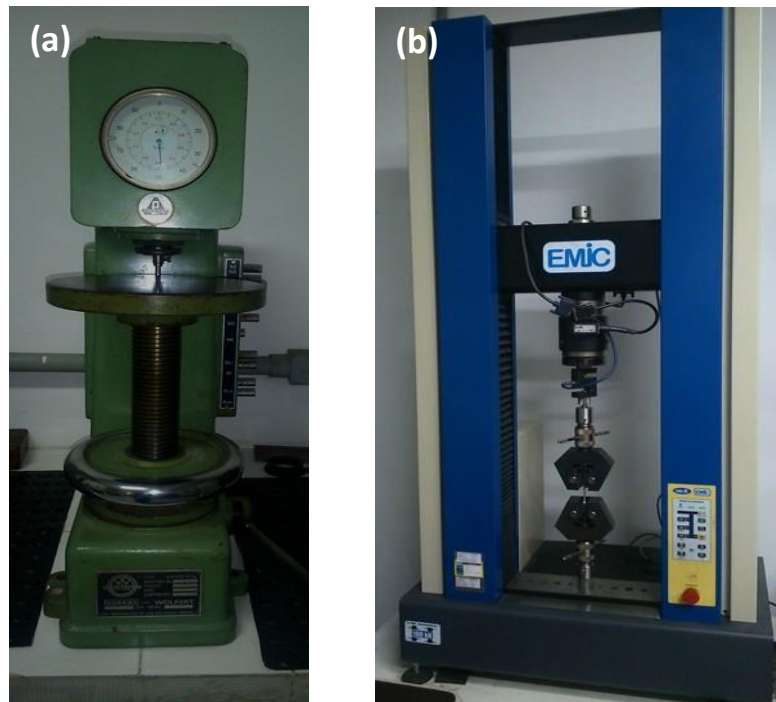
FIG. 3.4 Equipamentos para realização dos ensaios mecânicos nas amostras de liga de alumínio: (a) durômetro Wolpert Testor HT 1aa; (b) máquina de ensaios EMIC DL10000.
