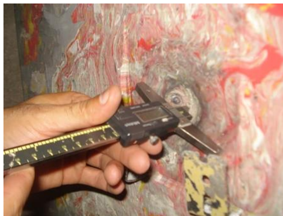
FIG. 3.16 Medida do trauma (indentação) no material de referência (plastilina).
