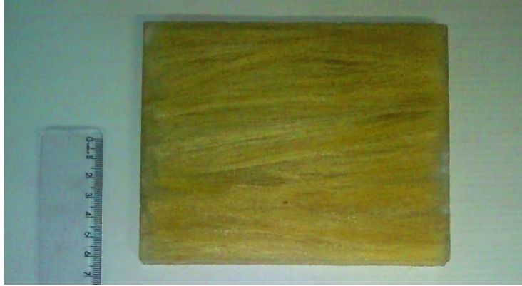
FIG. 3.12 Placa de compósito poliéster-fibra de Curauá produzida pela prensagem uniaxial.
