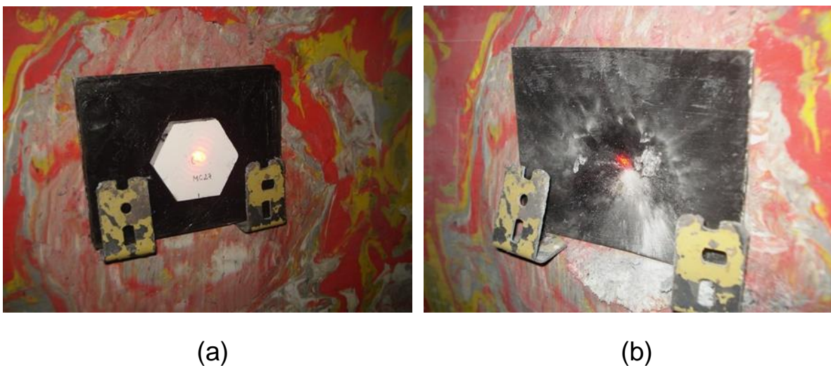
FIG. 4.13 Ensaio relativo à indentação atípica: corpo de prova com poliéster (a) antes e (b) após o impacto.
