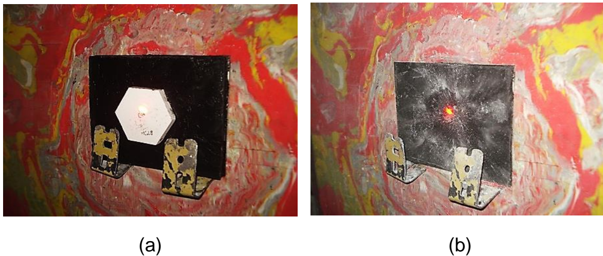
FIG. 4.11 Blindagem multicamada com poliéster puro: (a) Antes e (b) após o impacto balístico.
