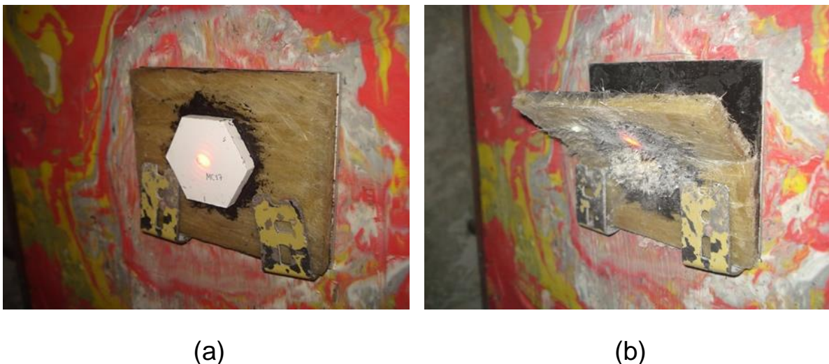
FIG. 4.20 Blindagem multicamada com 20% de Curauá: (a) Antes e (b) após o impacto balístico.
