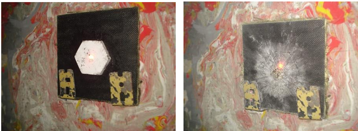
FIG. 4.7 Blindagem multicamada com tecido de aramida: (a) Antes e (b) após o impacto balístico.
