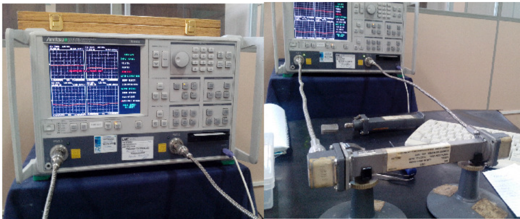
FIG. 5.6: Analisador de rede vetorial modelo 37247D Anritsu.
