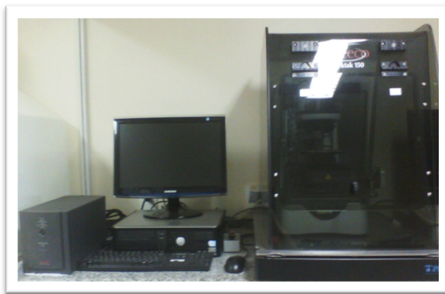
FIG. 5.1: Perfilômetro usado nas medidas de espessura.
