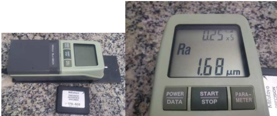
**FIG. 3 - Exemplo do resultado de rugosidade de uma das amostras.**
