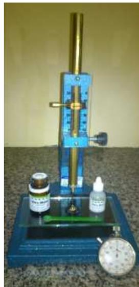
**FIG. 2 - Equipamento Vicat usado para determinar o tempo de cura do cimento.**
