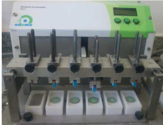
**FIG. 4 - Máquina usada para simular a escovação.**
