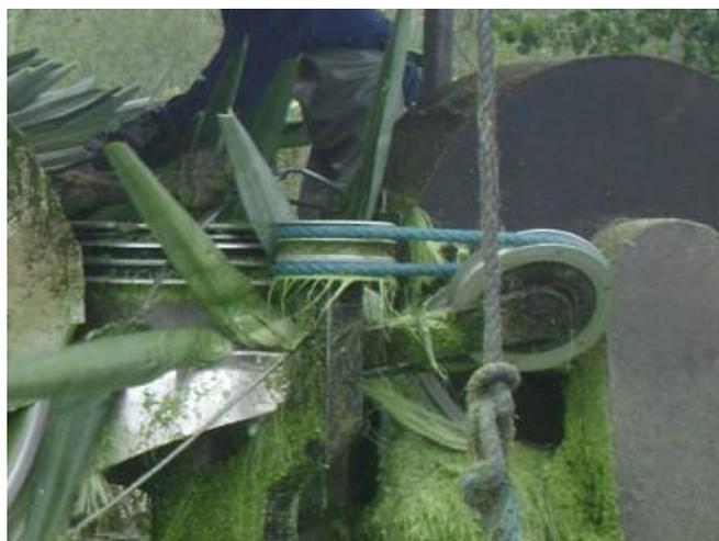
FIG. 2.8: Raspagem mecânica das folhas de sisal por meio da máquina desfibrador (Disponível em: <[http://www.cosibra.com.br/processos\\_estrutura.php](http://www.cosibra.com.br/processos_estrutura.php)>. Acesso em 16 de dezembro de 2014).
