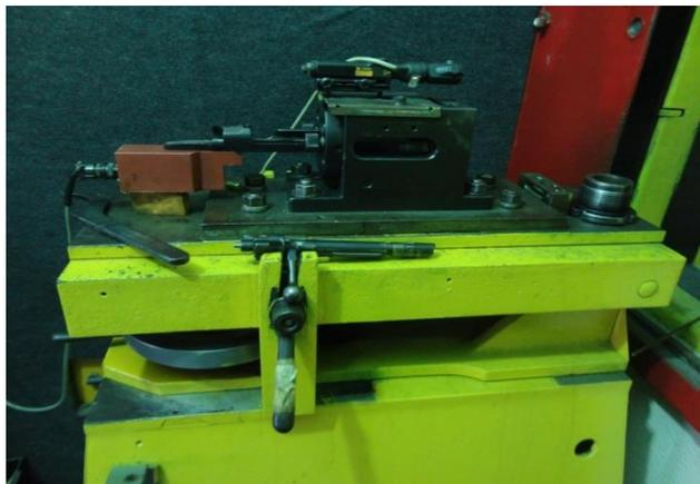
FIG. 3.24: Provete com calibre 7,62mm dotado de mira laser.
