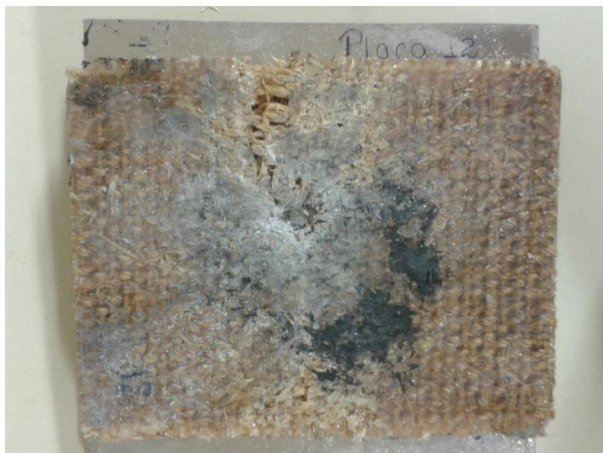
FIG. 4.14: Blindagem de compósito reforçado com tecido de sisal após ensaio balístico.
