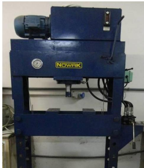
FIG. 3.13: Prensa motorizada com capacidade de 30 toneladas da marca Nowak.
