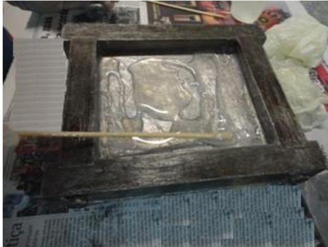
FIG. 3.18: Primeira camada de resina na matriz metálica.
