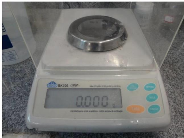
FIG. 3.8: Balança digital da marca GEHAKA, modelo BK 300, com precisão de 0,001g.
