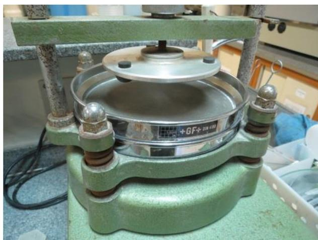
FIG. 3.11: Agitador de peneiras marca +GF+ tipo PSA.
