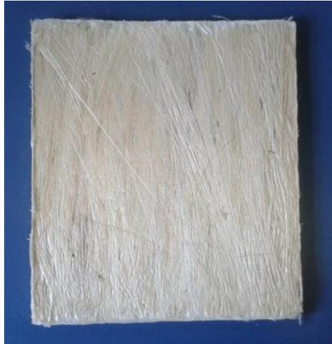
FIG. 3.22: Resultado final da placa compósita epóxi-fibra de sisal.
