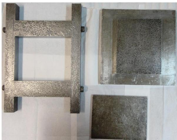
FIG. 3.16: Matriz metálica para confecção das placas compósitas.
