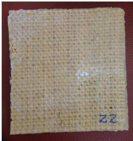
FIG. 3.23: Resultado final da placa compósita epóxi-tecido de sisal.
