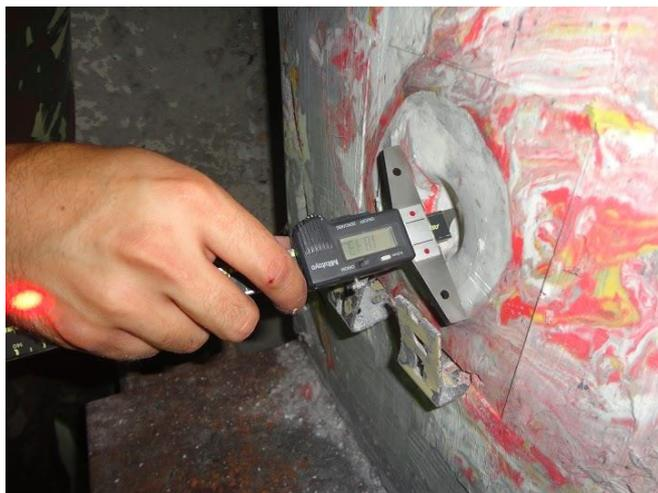
FIG. 3.29: Medição da profundidade da indentação gerada na plastilina após os ensaios balísticos.
