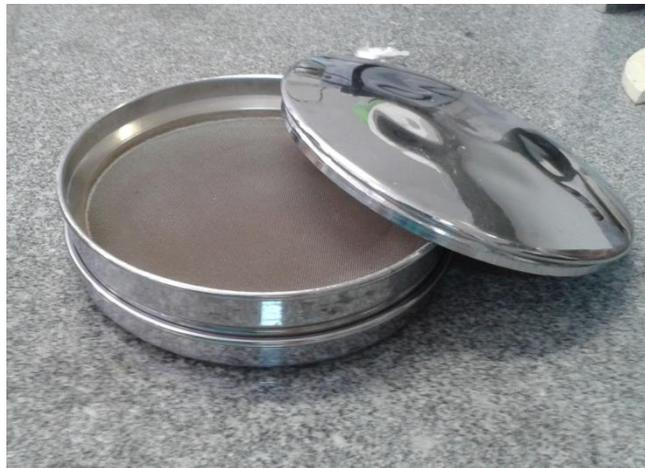
FIG. 3.10: Peneira com malha 0,355 mm.
