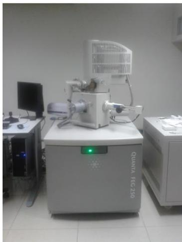
FIG. 3.30: Microscópio eletrônico de varredura modelo Quanta FEG 250.
