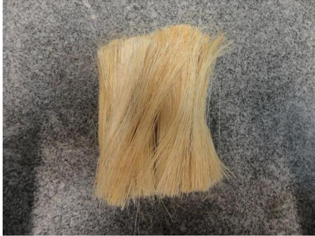
FIG. 3.17: Fibras de sisal secas com comprimento de aproximadamente 15 cm.
