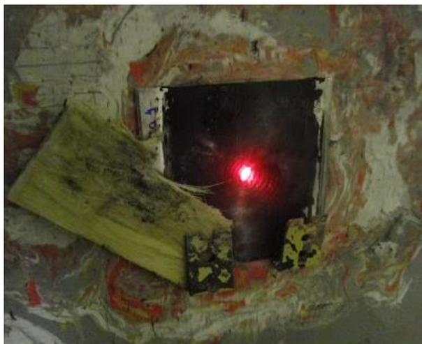
FIG. 4.3: Blindagem multicamada com compósito epóxi-fibra de sisal após o impacto balístico.
