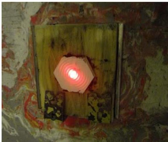
FIG. 4.1: Blindagem multicamada com compósito epóxi-fibra de sisal antes do impacto balístico.
