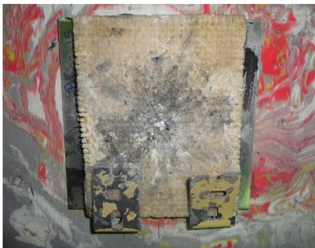
FIG. 4.4: Blindagem multicamada com compósito epóxi-tecido de sisal após o ensaio balístico.
