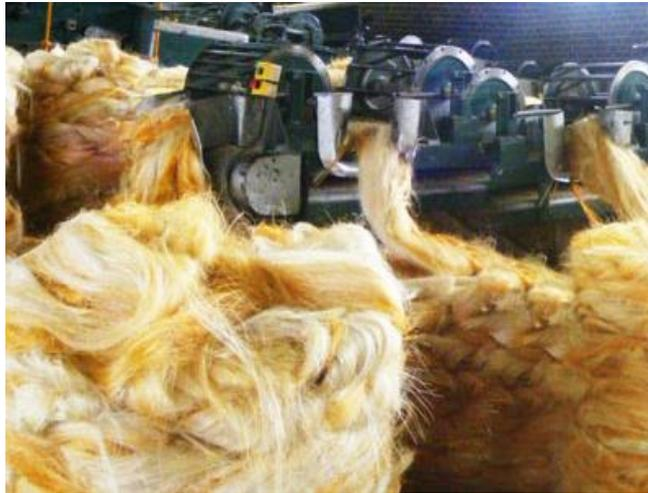
FIG. 2.10: Penteamento e estiragem das fibras (Disponível em: <[http://www.cosibra.com.br/processos\\_estrutura.php](http://www.cosibra.com.br/processos_estrutura.php)>. Acesso em 16 de dezembro de 2014).
