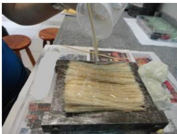
FIG. 3.20: Última camada de resina sobre as fibras de sisal.
