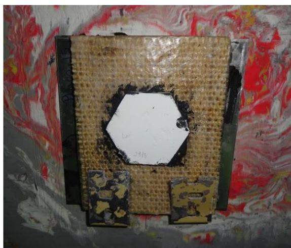
FIG. 4.2: Blindagem multicamada com compósito epóxi-tecido de sisal antes do impacto balístico.
