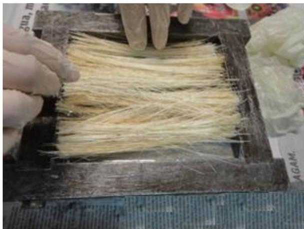
FIG. 3.19: Deposição da camada de fibras de sisal alinhadas sobre a resina.
