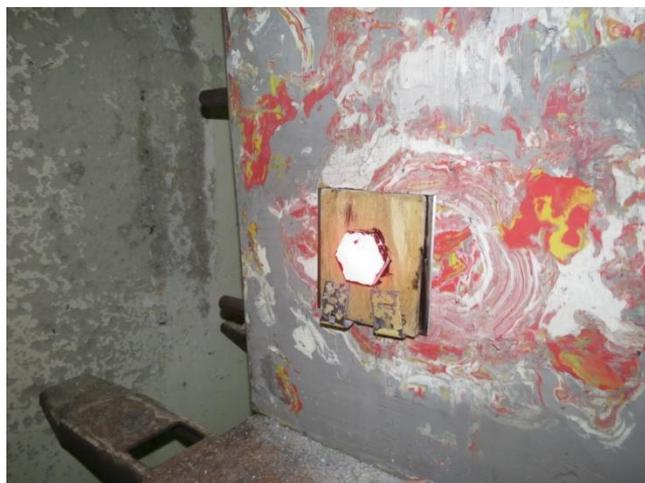
FIG. 3.26: Dispositivo de fixação do alvo na plastilina.
