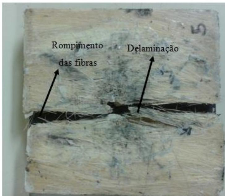
FIG. 4.12: Delaminação e rompimento das fibras do composto reforçado com fibras de sisal.
