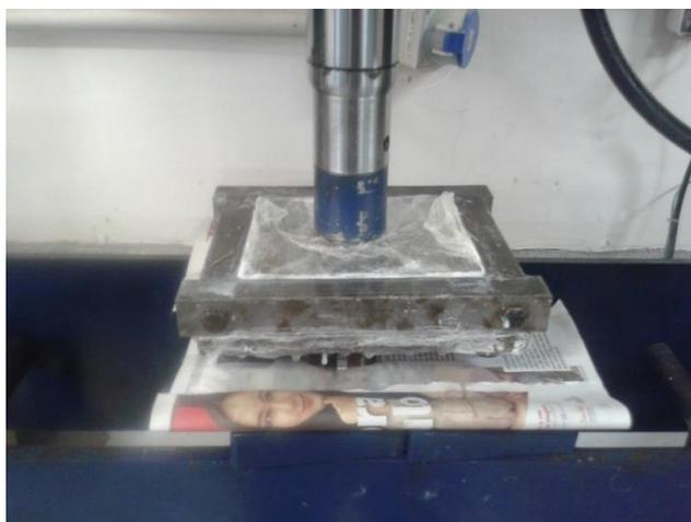
FIG. 3.21: Placa compósita submetida à pressão para a cura.
