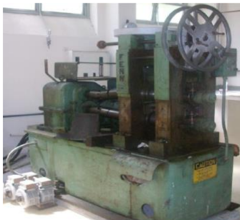
FIG 4.6: Laminador FENN MFG. Co., modelo D 51710 de 1973. Laboratório de Processamento Mecânico do IME.
