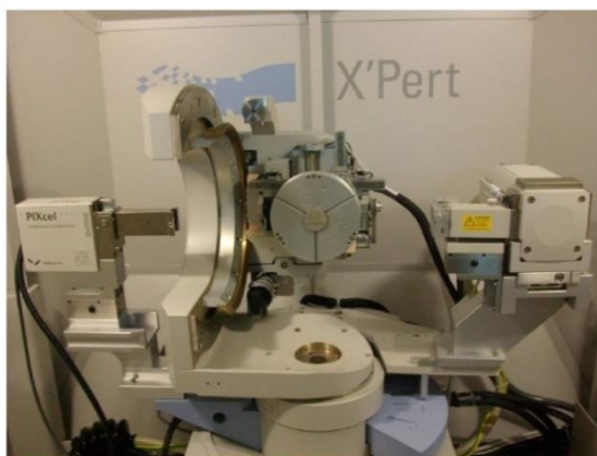
FIG 4.8: PANalytical X'Pert PRO MRD do laboratório de difração de raios-x do IME
