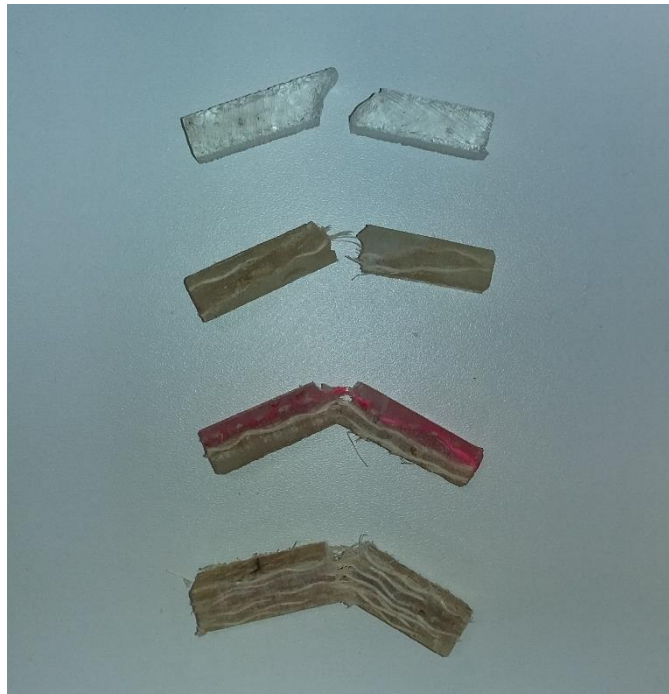
FIG. 4.5: Típicas fraturas de corpos de provas por testes de impacto Izod.
