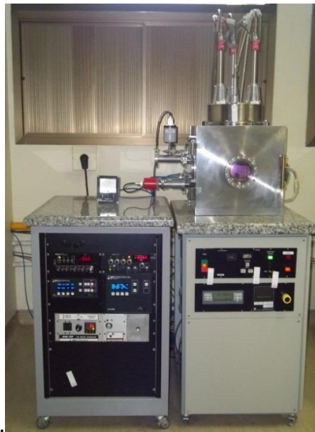
FIG. 42 Vista do equipamento de pulverização catódica por RF assistida por campo magnético.
