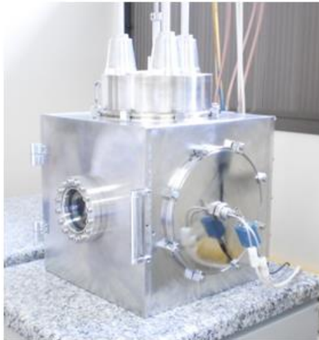
FIG. 43 Tampa circular de aço inox “ISO 200” na face lateral do sistema de deposição.
