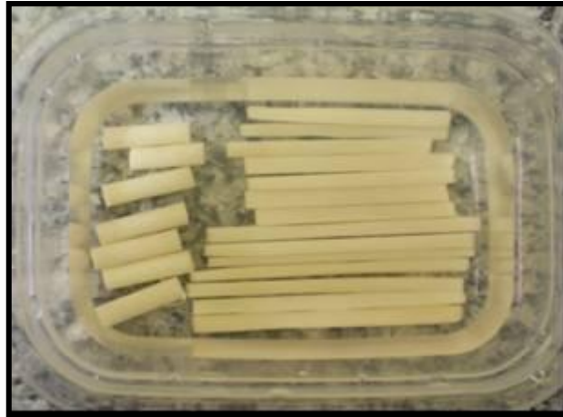
FIG. 5.6 - Corpos de prova com forma cilíndrica e de paralelepípedo em solução para manter a hidratação.
