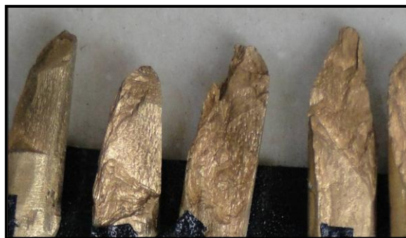
FIG 7.18 – Aspecto do corpo-de-prova longitudinal submetido ao ensaio de torção.
