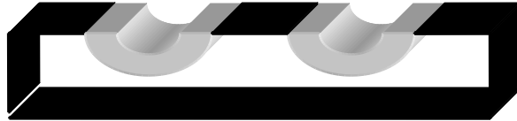
FIG. 3.1 - Esboço do corpo-de-prova utilizado no trabalho realizado por NALLA et al. (2003, 2005), com duplo entalhe em cada corpo-de-prova.
