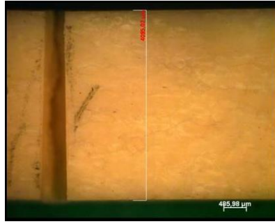
FIG.5.2 Exemplo medição da largura do corpo-de-prova antes do ensaio de flexão.
