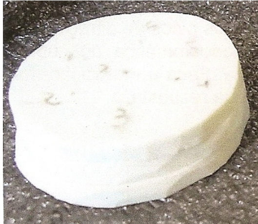
FIG. 3.6 – Fotografia do corpo de prova utilizado no ensaio de dureza Shore, onde as três camadas do empilhamento podem ser visualizadas
