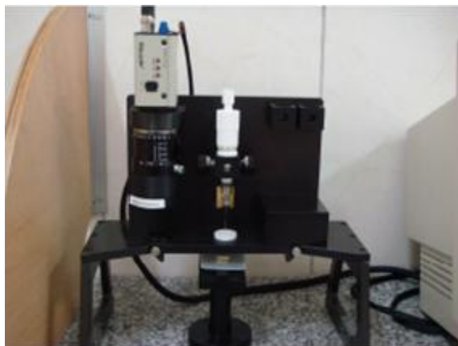
FIG. 3.5 – Goniômetro marca First Ten Ångstroms, modelo FTA 100
